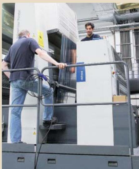
Abb. 1 Testeinsatz von Kaltfolie für Metalleffekte bei Recyclingpapier Fotos: Lohmann Druck
